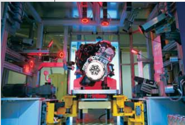
Prüfen der Motoren mittels eines optischen Kamerasystems
